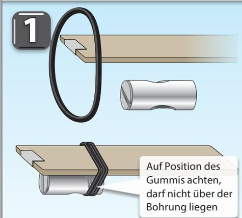
Quergewindebolzen M6 mit Gummiband an Zollstock oder Holzleiste (bauseits) fixieren, sodass das Gewinde nach unten zeigt.
