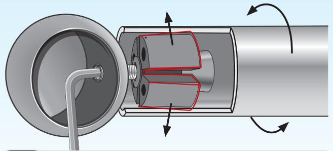
**1** Gewindestift M8x35 in seitliche Bohrung der Kugel schrauben. Dann Tellerfeder, Rohrkupplung aufstecken und mit Klemmkonus M8 handfest verschrauben. Abschließend Handlauf über die Rohrkupplung stecken
