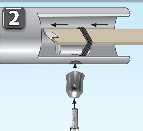
Fixierten Quergewindebolzen M6 mit Zollstock in Handlaufrohr bis zur Bohrung einführen. Von außen Handlaufhalter mit Inbusschraube M6 x 12 in Quergewindebolzen einfügen.
