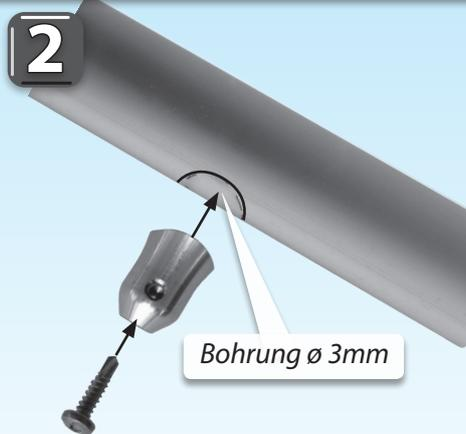
Gewindestift M6 lösen, Handlaufhalter abziehen und anschliessen mit Bohrschraube 4,9x 19 (Aluhandlauf) fixieren.
