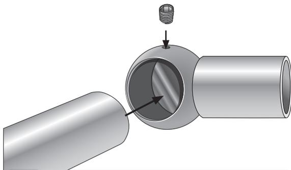
**3** Zweiten Handlauf in Rohröffnung stecken und mit Gewindestift M6x6 fixieren.
