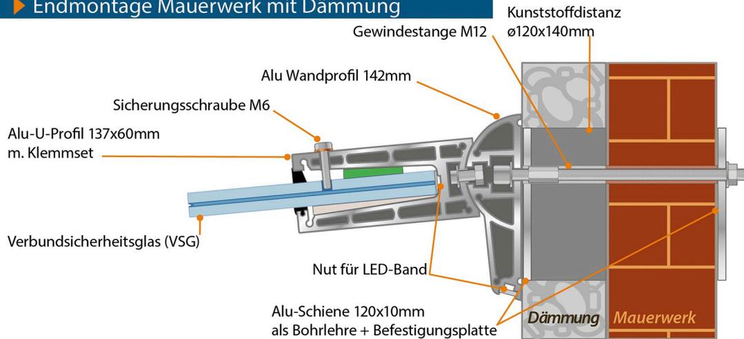
► Vormontage Mauerwerk mit Dämmung
