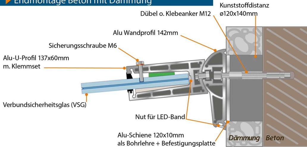
► Vormontage Beton mit Dämmung
