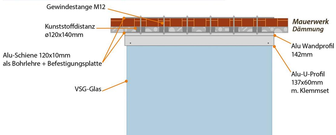
► Endmontage Beton mit Dämmung
