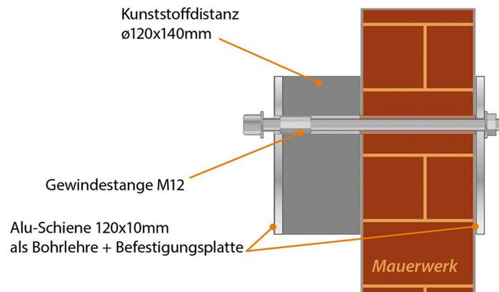
► Mauerwerk mit Dämmung
