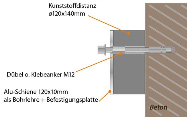
► Beton mit Dämmung
