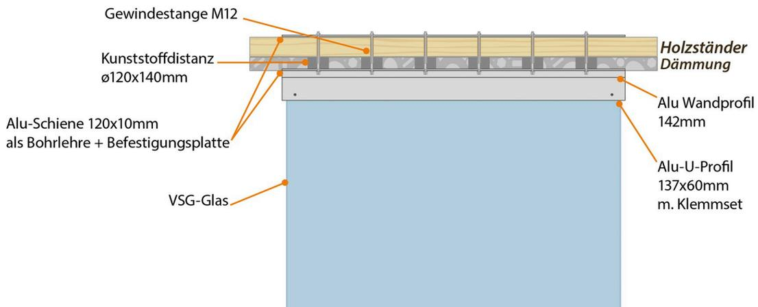
► Endmontage Mauerwerk mit Dämmung
